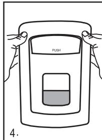
4. Cómo cerrar el dispensador: gire la cubierta frontal hacia arriba, luego presione en ambos lados de la parte superior con los dedos pulgares como se muestra. Aplique una presión uniforme hasta que quede herméticamente cerrado. ¡NO PRESIONE EL PULSADOR PARA CERRAR!
