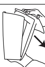
4. Para ABRIR, inserte la llave en las ranuras de la traba en el fondo del dispensador y presione la llave hacia arriba. Apóyese su otra mano encima del dispensador y guíe la cubierta del frente hacia adelante.
