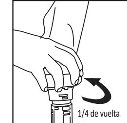
Gire el Collar de la bolsa 1/4 de vuelta en sentido antihorario para sellar la Bolsa de recarga y la Base de recarga. Retire la Boquilla de la Base de recarga.
